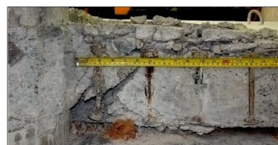
b) Tração diagonal na região armada ( V_{R,cs} ) (FERREIRA, 2010)
