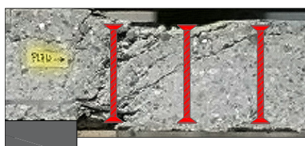
a) Esmagamento da biela ( V_{R,max} ) (Adaptado de LIPS, 2012)
