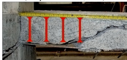
c) Ruptura fora da região armada ( V_{R,out} ) (Adaptado de FERREIRA, 2010)
